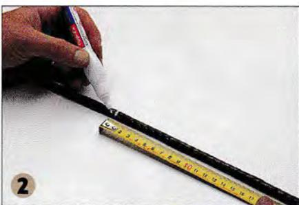
▲ Ici, le cordage fait 8 mm de diamètre. Une première marque est donc faite à 40 cm de l'extrémité de la tresse ( $50 \times 8 = 400$  mm).
