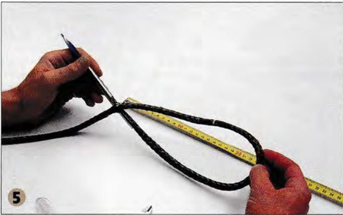
► Il faut attention à ne pas abîmer les fibres en les accrochant avec l'aiguille à épisser. Il veille également à ce qu'il y ait le même nombre de fuseaux de chaque côté de l'aiguille.
