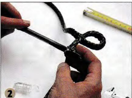
▲ Il enfile ensuite l'autre extrémité de la tresse dans l'aiguille qu'il passe au travers de la marque 1.
