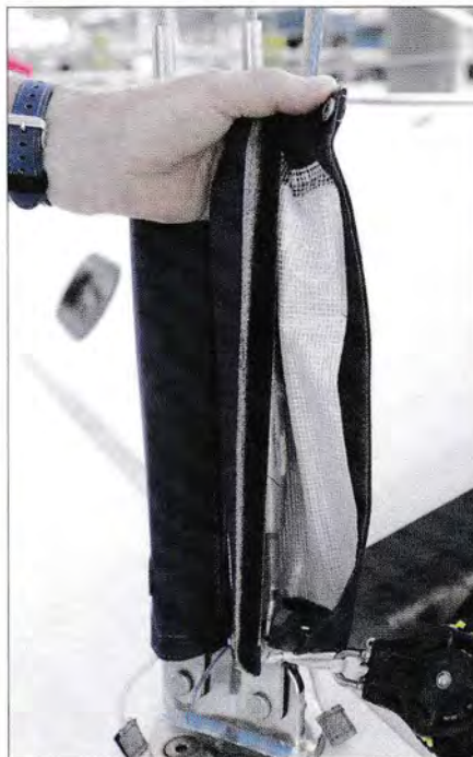
▲ Des protège-ridoirs souples et amovibles pour changer la tension quand la pression monte.
