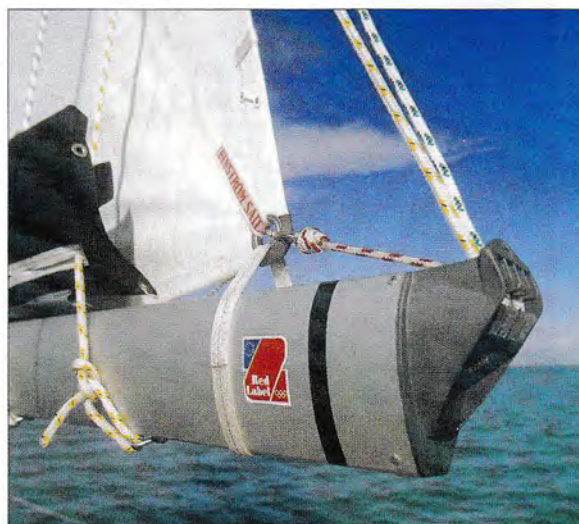
▲ Pas besoin de faire des coutures avec une sangle cravate agrippante pour maintenir le point d'écoute de la grand-voile.
