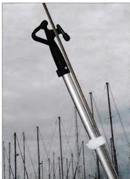
▲ Un morceau de Velcro sur le pataras pour avoir la gaffe prête à l'usage.
