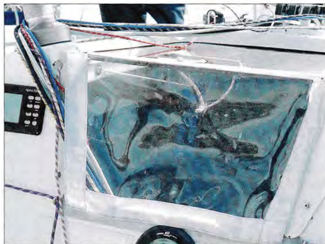
▲ Ce panneau de descente souple fait maison protège l'intérieur des embruns et de la pluie et permet de jeter les drisses dans la descente.
