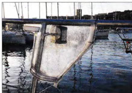
▲ Une protection faite maison de feux de nav pour ne pas piéger les écoutes de spi.
