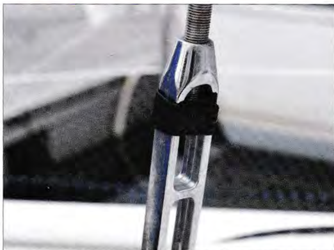
▲ Avec un axe fixé sur une bande auto-agrippante, cette goupille est très utile et ne nécessite aucun outillage pour changer la tension du gréement.
