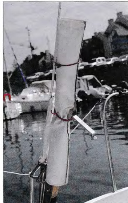
▲ Un morceau de bâche, une bande de scratch, deux sandows et la barre est protégée.
