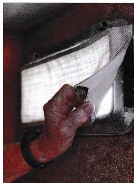
▲ Pour maintenir de l'obscurité, deux bandes de Velcro sur les rideaux et le cadre du hublot.
