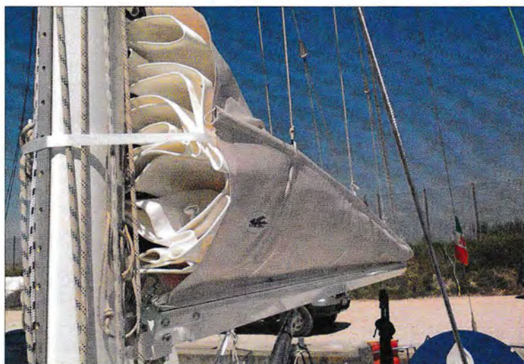
▲ Un ruban de Velcro remplace parfaitement la fermeture Eclair d'un lazy bag, d'autant qu'avec le sel et l'humidité, cette dernière a tendance à se gripper.
