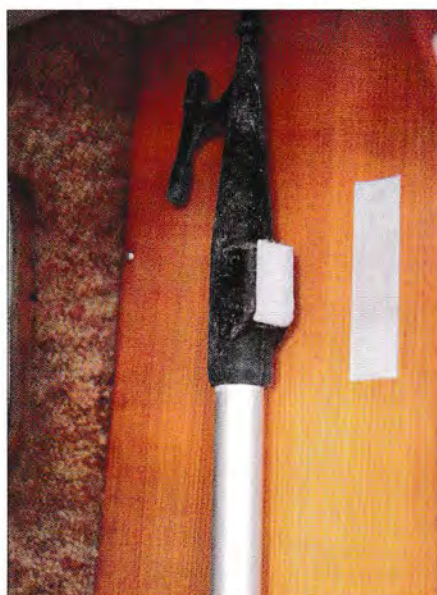
▲ Un morceau sur la tête de la gaffe, l'autre sur le vaigrage et la bête reste en place.
