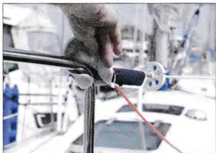
▲ Il existe des protections pour balcon prêtes à l'emploi, ici sécurisées avec un collier plastique.
