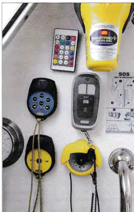
▲ Ici, à bord d'un Pogo 10.50, l'usage du Velcro a été pensé pour tout avoir à portée de main, notamment les télécommandes du pilote ou encore le compas de relèvement.
