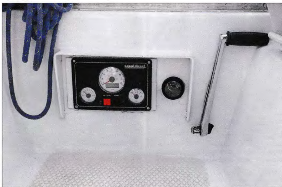
▲ A la différence d'un étui à manivelle, cette installation auto-grippante n'accumule pas les miettes et les saletés, ne prend pas de place et s'installe sans outillage.
