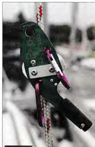
▲ Pour permettre à L'Olivette de coulisser à l'ascension, les coinceurs sont dans le même axe que la drisse.
