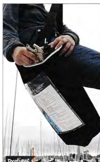
▲ Un mousqueton que l'on fixe sur la manille du bloqueur permet de rapprocher la chaise de la tête de mât.
