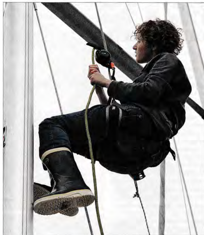
▲ Ici, le descendeur est sur « Lock » car on a retiré la poignée-bloqueur. À la descente, on tire la poignée du descendeur vers soi (mode « Descent »).
