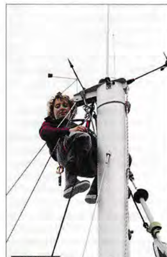
▲ Une courroie passée autour du cou et reliée à L'Olivette améliore l'efficacité à la montée.
