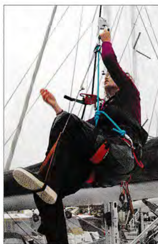
▲ Dès que L'Olivette est sous tension, elle se bloque sur la drisse en forçant celle-ci à former un S.
