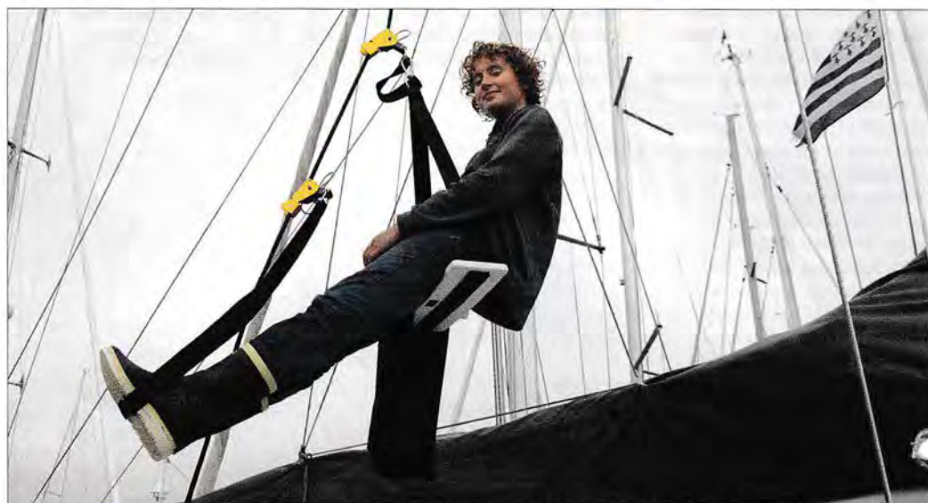
▲ Un mousqueton que l'on fixe sur la manille du bloqueur permet de rapprocher la chaise de la tête de mât.
