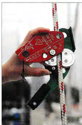
▲ Pour permettre à L'Olivette de coulisser à l'ascension, les coinceurs sont dans le même axe que la drisse.
