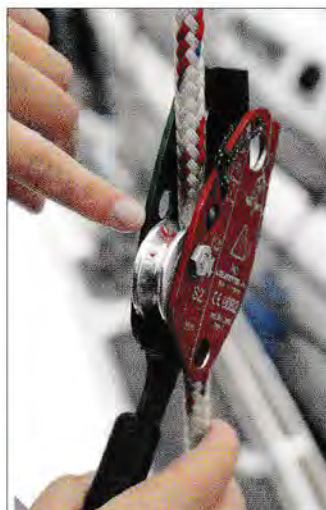
▲ Dès que L'Olivette est sous tension, elle se bloque sur la drisse en forçant celle-ci à former un S.
