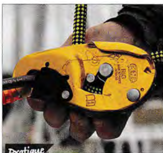
▲ Pour se hisser, on pousse sur la pédale (pied droit) et on tire sur le dormant (main gauche). Puis on s'assoit, puis on monte le bloqueur (main droite).
