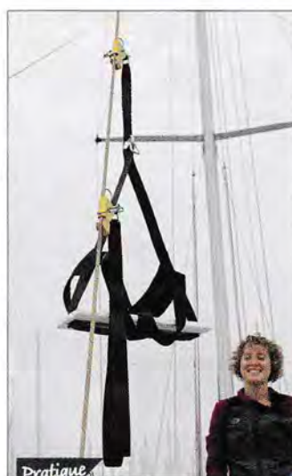
▲ Un mousqueton que l'on fixe sur la manille du bloqueur permet de rapprocher la chaise de la tête de mât.
