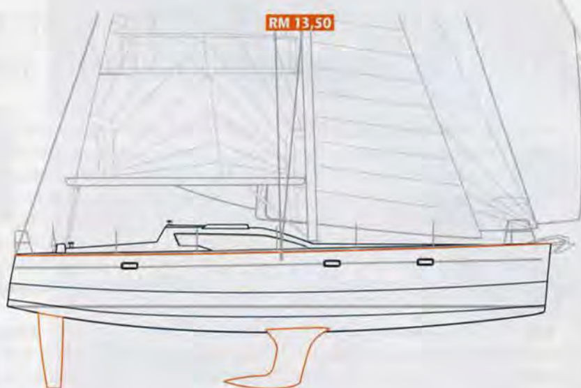
RM 13,50 Safran dans l'axe et tirant d'eau de 1,95 m avec deux ailerons de 1 555 kg chacun.
