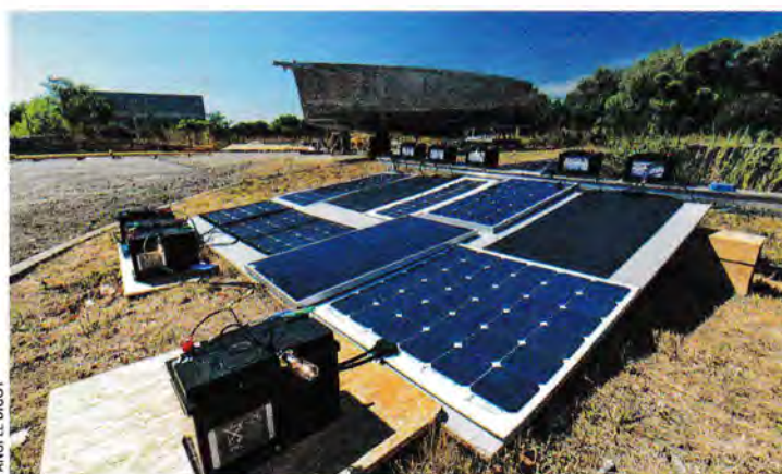
Lors d'un récent comparatif de panneaux solaires (VV n° 559), on a pu constater qu'avec un panneau de 100 watts, dans des conditions optimales, on pouvait obtenir environ 60 watts.
