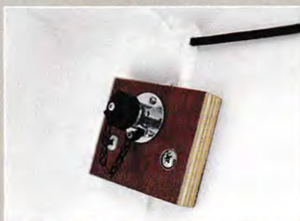
▲ C'est dans le triangle avant qu'on branche le câble du panneau solaire baladeur.
