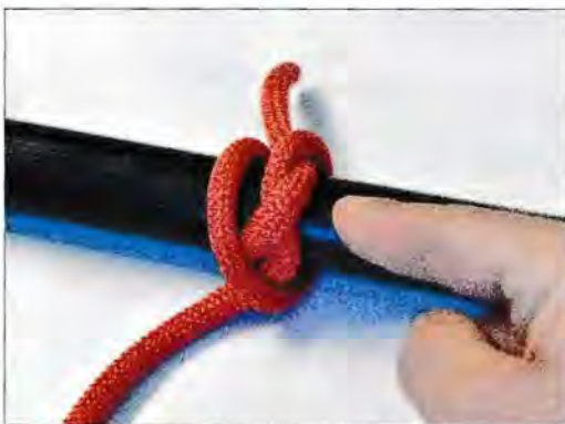
▲ Le nœud constricteur est un nœud simple (demi-clé) verrouillé par un brin qui appuie en son centre (ici décalé sur le côté à gauche).
