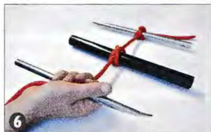
6 ▲ Le nœud empêche l'aiguille de glisser et permet de l'utiliser comme poignée.
