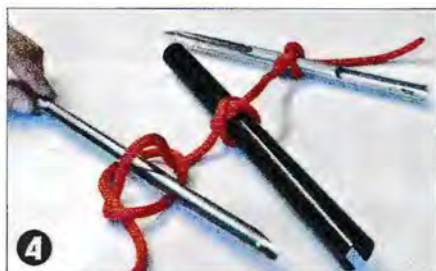
4 ▲ Insérez l'objet qui sert de poignée (ici une aiguille creuse) au centre de la boucle.
