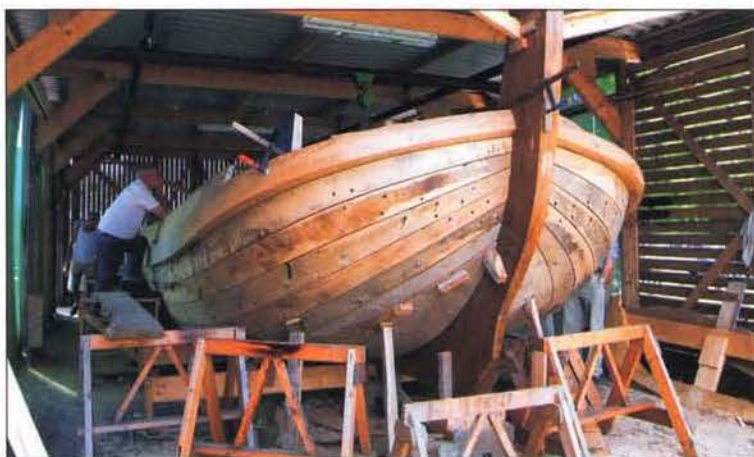
Chantier au musée d'Eernewâld. Commencée en 2004, la coque en chêne d'Aebelina est la réplique d'un fameux ferry construit en 1861.
