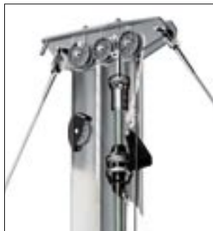
Mât enrouleur Seldén : Winch d'enroulement à renvoi d'angle, profilé sous tension, fenêtre décalée et émerillon de drisse à répartiteur de charge breveté. Tout pour rendre la réduction de voile facile et rapide.
