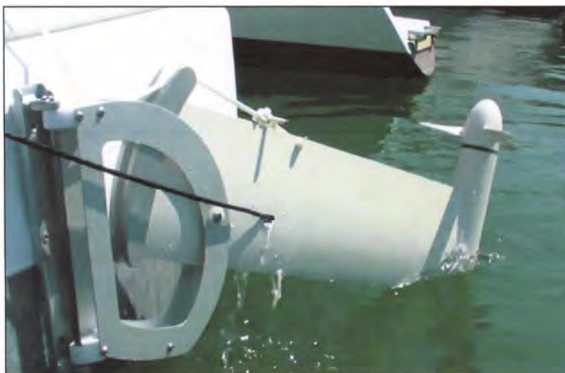
Figure 8 : Relevage de l'hydrogénérateur
