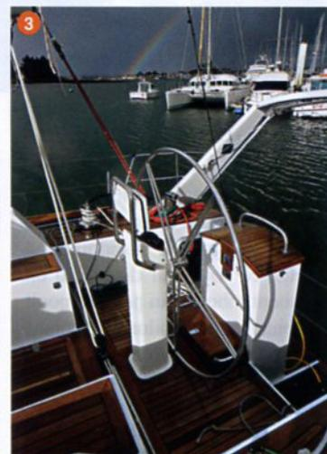
1 Les hiloires de cockpit protègent bien l'équipage et cachent des rangements pour le petit matériel. 2 Génois et trinquette sont sur enrouleur pour faciliter les combinaisons de voilure. 3 Le barreur est très bien installé derrière sa grande barre à roue, laissant une circulation facile vers la jupe.
