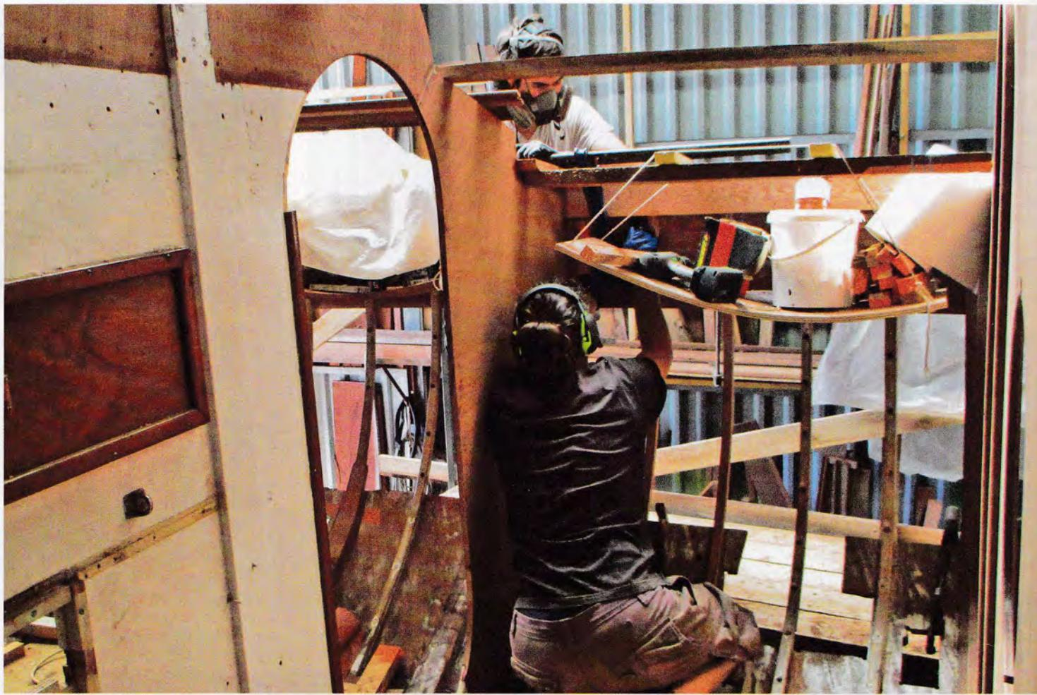
fait une ou deux pour voir, puis on les a toutes remplacées par du lamellé-collé dans la mesure où cela va davantage dans le sens de la restauration et donne une meilleure raideur à l'ensemble.»
