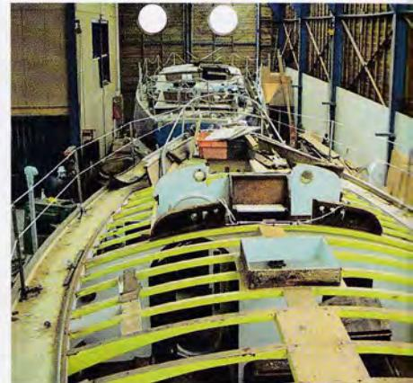
**Structure de course.** Sur une charpente sans lisse longitudinale, l'épais bordé en bois moulé assure la raideur de la coque.
