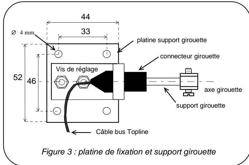
Figure 3 : platine de fixation et support girouette
