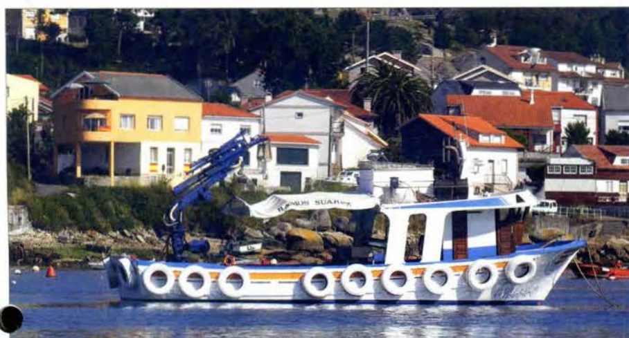
▲ Les bateaux utilisés pour la production des moules sont typiques, avec une étrave assez peu défendue (ils n'ont pas à affronter le large), et leur grue hydraulique sur l'arrière.
