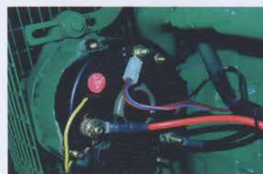
LA BORNE D+ EST EN GÉNÉRAL RELIÉE AVEC DU CÂBLE FIN.
