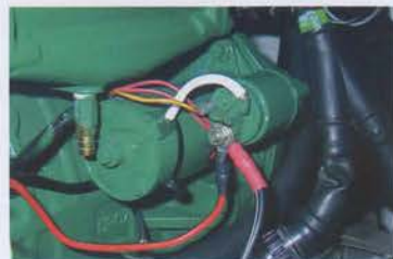
CE FIN CÂBLE ROUGE ET JAUNE MET LE DÉMARREUR EN ROUTE.
