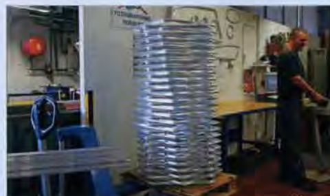
L'entourage en aluminium des panneaux est cintré dans une machine à partir d'un profil rectiligne.
