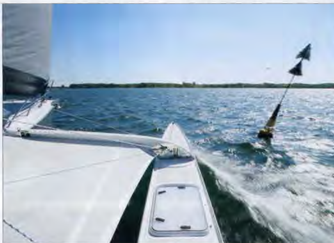
Sur la face arrière du bras, la pièce en inox assurant la rotation lors du pliage du bras. Sur le flotteur, le panneau ouvrant réalisé par BSI.
