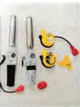
Les déclencheurs : à gauche le modèle manuel, puis les modèles automatiques UML5, Pro Sensor Elite ; et à droite les deux Hammar, à remplacer tous les cinq ans (M1 en haut, MA1 en bas). Mis à part le MA1, ils peuvent tous être remplacés par l'utilisateur.
