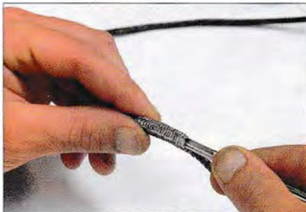
▲ L'aiguille creuse ne permet pas de faire des épissures sur des cordages en-dessous de 4 mm. Trop large, l'aiguille reste bloquée à l'intérieur de la tresse.
