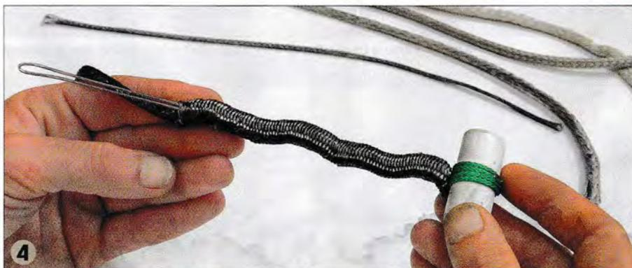
▲ Pour faire progresser l'aiguille à long chas, on comprime la tresse en la poussant contre la poignée. On ressort l'aiguille au niveau de la première marque en passant bien entre deux fuseaux.
