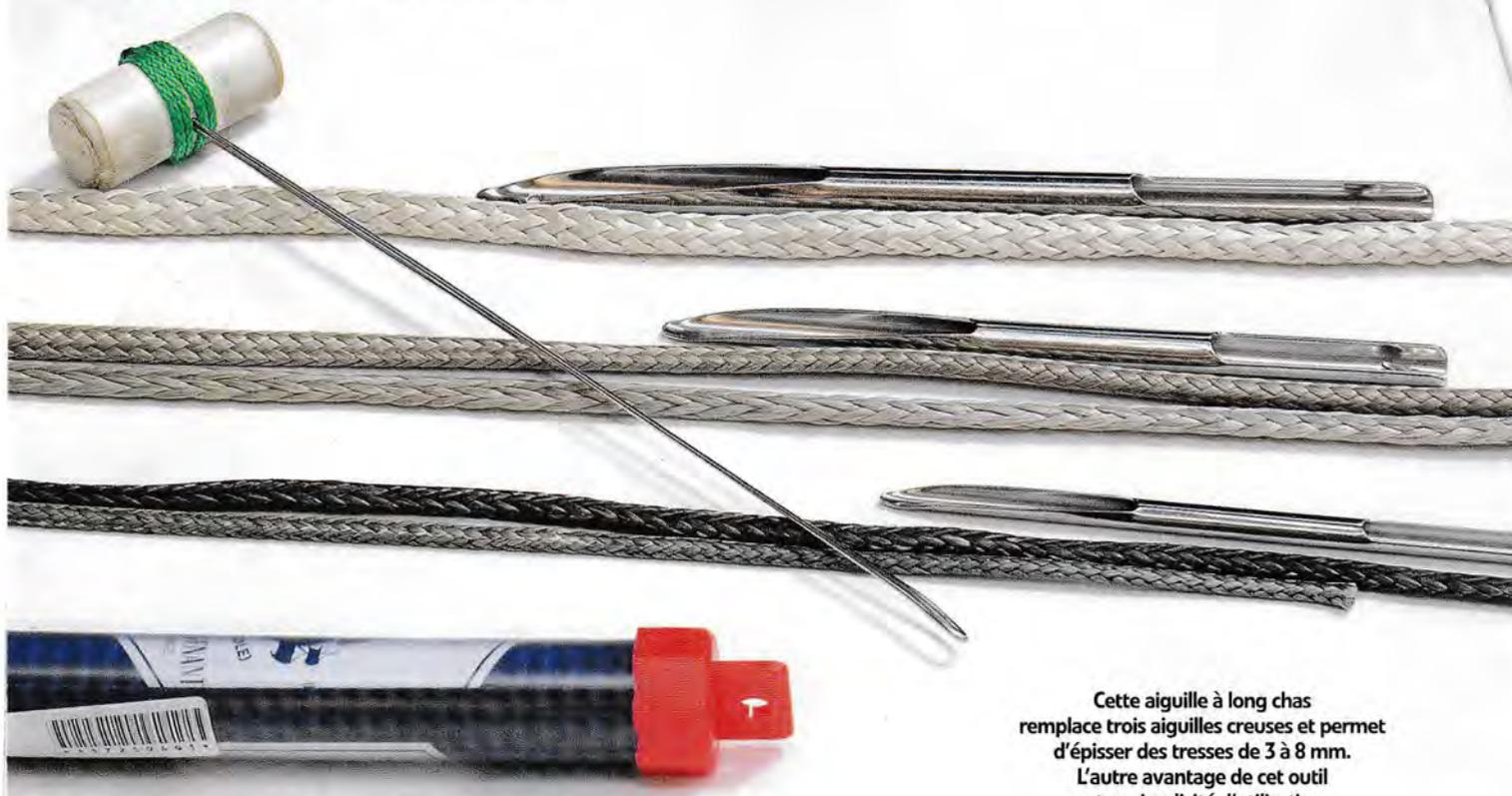
Cette aiguille à long chas remplace trois aiguilles creuses et permet d'épisser des tresses de 3 à 8 mm. L'autre avantage de cet outil est sa simplicité d'utilisation.
