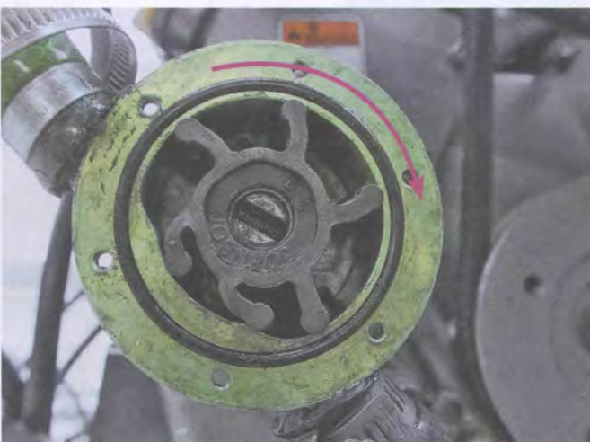
La pompe eau de mer ouverte, avec le joint torique bien visible.
