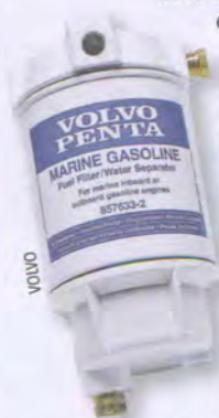
Filtre décanter et sa cartouche. En ouvrant le bouchon du bas, on purge le décanter.
