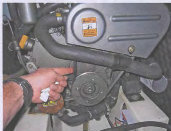
On mesure la flèche de la courroie en appuyant avec le doigt.
