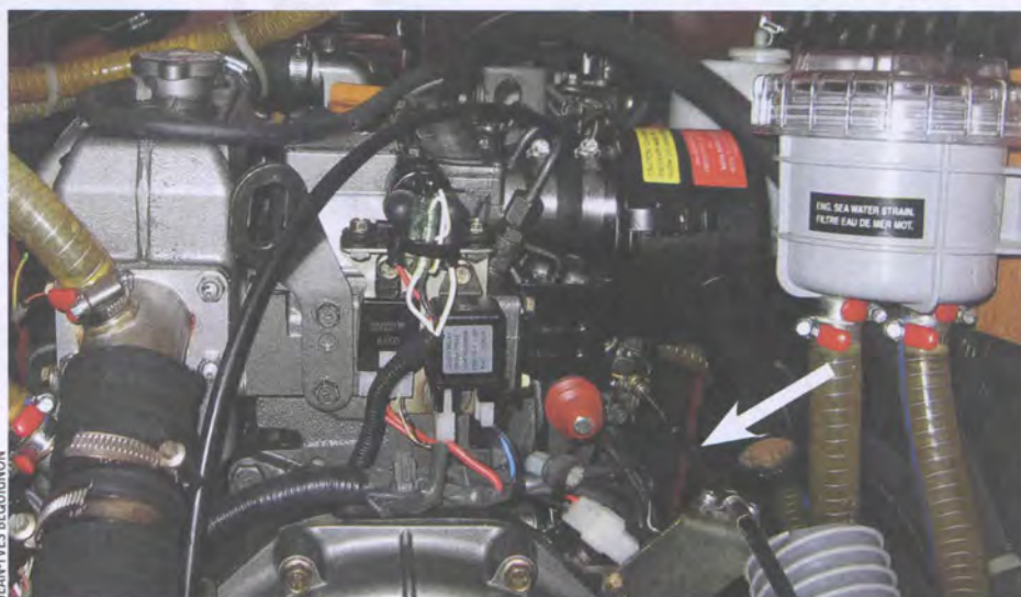
Sur ce moteur, le câble des gaz est plus facilement accessible par l'arrière et on ne risque pas de se pencher au-dessus du moteur chaud.
