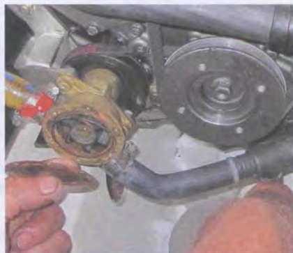
Démontage du capot de la pompe. Avant d'ouvrir la pompe eau de mer, mettre un récipient pour récupérer l'eau.
