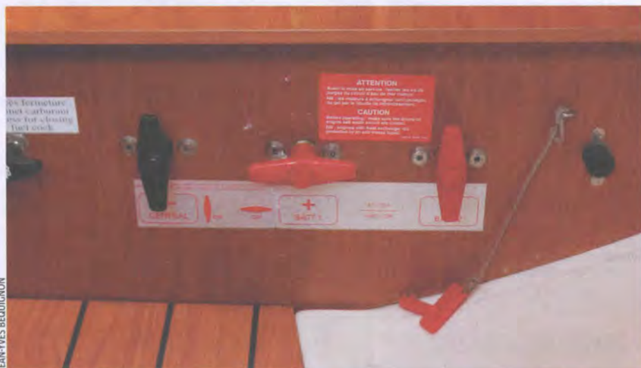
Le coupleur permet d'utiliser les batteries de servitude pour tenter de parer à une défaillance de la batterie moteur. L'essai ne doit durer que quelques secondes.
