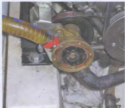
Démontage du capot de la pompe. Avant d'ouvrir la pompe eau de mer, mettre un récipient pour récupérer l'eau.
