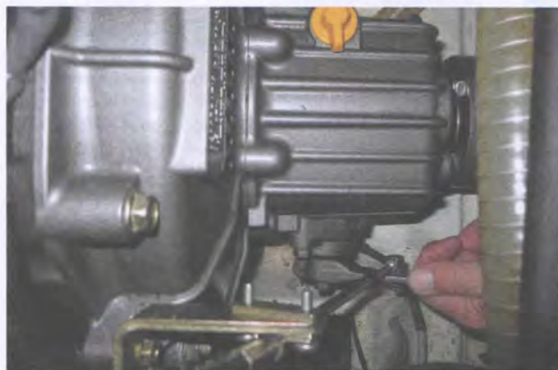
Quand on actionne à la main l'inverseur, attention à l'arbre d'hélice qui tourne pas très loin.
