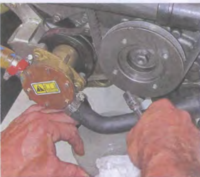
Démontage du capot de la pompe. Avant d'ouvrir la pompe eau de mer, mettre un récipient pour récupérer l'eau.
