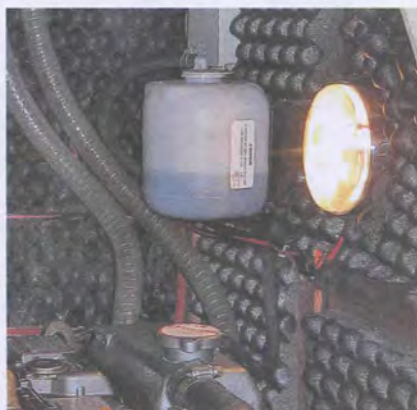
Le niveau du liquide de refroidissement apparaît sur le vase d'expansion. Il doit se situer entre «MIN» et «MAX».
