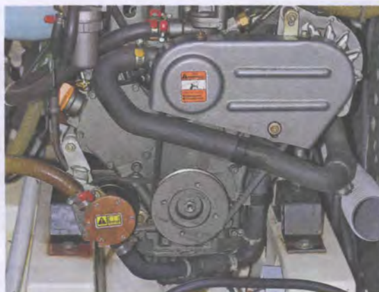
Sur les Yanmar, il y a deux courroies, l'une trapézoïdale, qui entraîne la pompe eau douce et l'alternateur, et l'autre qui entraîne la pompe eau de mer.
