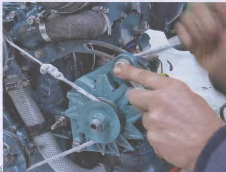
On mesure la flèche de la courroie en appuyant avec le doigt.
