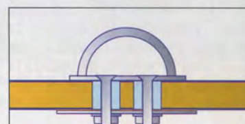
Une cadène fil doit être boulonnée au travers d'inserts et d'une contreplaque collée.
