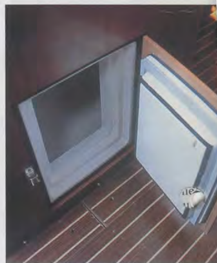
Le réfrigérateur à ouverture frontale, très prisé, est une catastrophe pour la conservation du froid.
