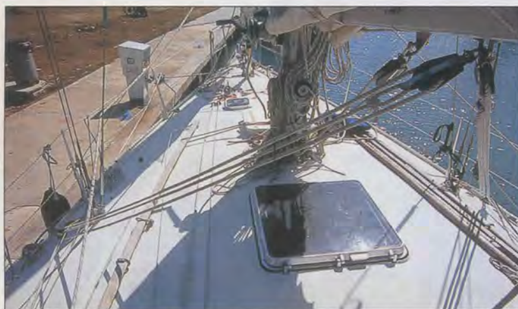
A bord de Fleur Australe de Philippe Poupon, les retenues de bôme à poste sont réalisées en Nylon pour un maximum d'élasticité.
