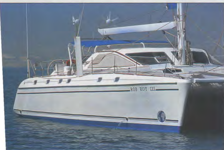
A bord de ce Catana, l'équipage s'est pris les pieds dans le tapis : les deux éoliennes ne suffisent pas à compenser la consommation au mouillage et le groupe dont on aperçoit l'échappement doit prendre le relais. Il est possible de faire autrement...
