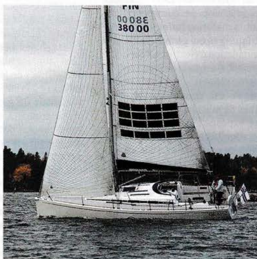
A bord de cet Arcona 380 Z, pas moins de 2 kilowatts de panneaux solaires au total... en comptant la voile.
