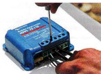
Ces régulateurs Victron nous ont permis d'enregistrer toutes les données de production.
