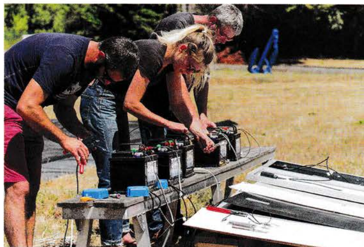
Le montage de notre banc d'essai. Chaque panneau était connecté à sa propre batterie afin de reproduire au mieux une situation réelle.
