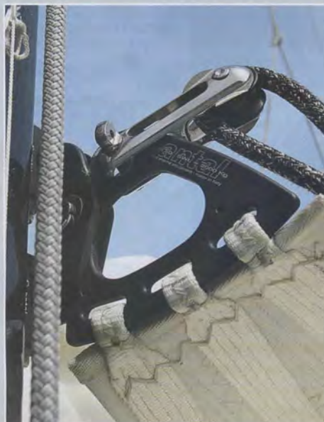
▲ Une drisse mouflée est un palan à deux brins dont la partie mobile est la tête de grand-voile.
