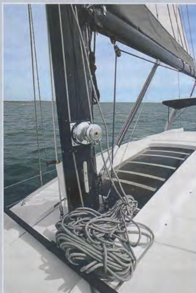
▲ Inconvénient du système : une drisse deux fois plus longue à récupérer en pied de mât!
