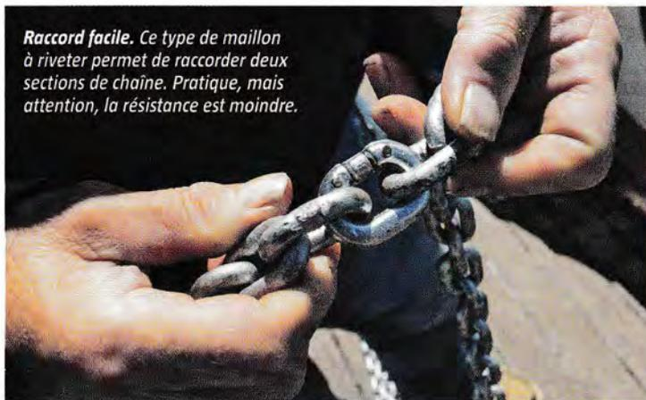
**Raccord facile.** Ce type de maillon à riveter permet de raccorder deux sections de chaîne. Pratique, mais attention, la résistance est moindre.
