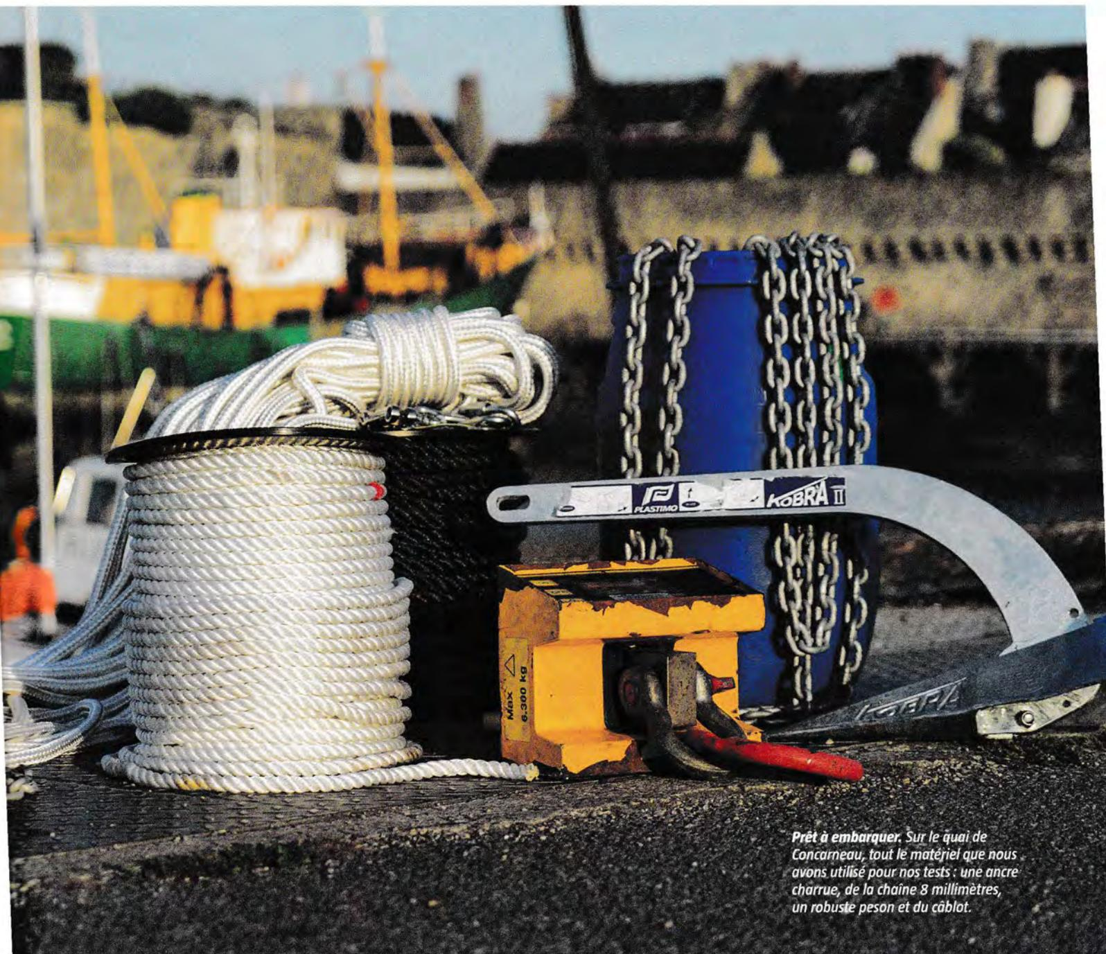
Prêt à embarquer. Sur le quai de Concarneau, tout le matériel que nous avons utilisé pour nos tests : une ancre charrie, de la chaîne 8 millimètres, un robuste peson et du câblot.
