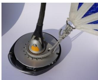
Il est également possible de créer un système permettant d'ajuster l'amure. Pour cela, il est recommandé d'attacher une poulie au point d'amure tournant. Le cordage de l'amure passera alors par la poulie et un nœud sera fait sur la voile. Lors de l'enroulement, il est important de reprendre la tension sur l'amure avant d'enrouler la voile (tendre au maximum le guindant).
