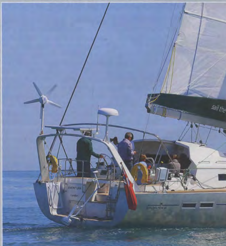
▲ Eolienne, panneau solaire et hydrogénérateur : quand on part loin et longtemps comme ce Garcia Exploration 45, mieux vaut multiplier les sources d'énergie.
