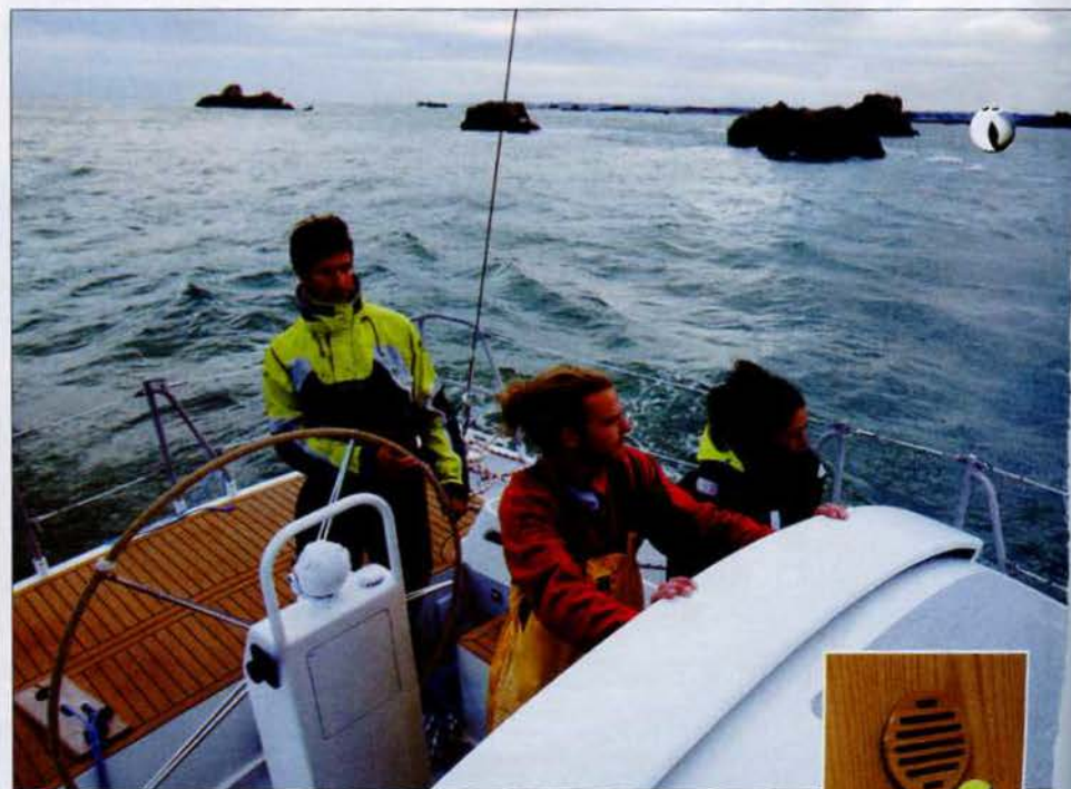
▲ L'arceau du dog-house est en fait une manche à air dotée d'ailettes internes qui force la ventilation dans les cabines arrière (grille de sortie en insert).
