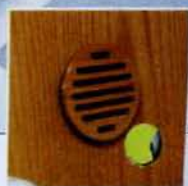
▲ L'arceau du dog-house est en fait une manche à air dotée d'ailettes internes qui force la ventilation dans les cabines arrière (grille de sortie en insert).
