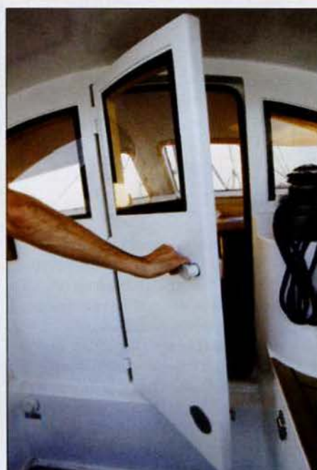
▲ L'épaisse porte du dog-house et sa solide poignée sont une sécurité contre la mer, mais aussi contre les visiteurs indésirables. La serrure bien protégée se situe en bas à droite.
