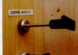
L'immense soute arrière est verrouillée par un gros loquet commandé depuis le poste de navigation.
