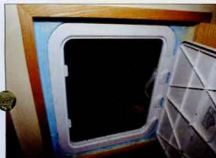
▲ En cas de « vrac », la baille à mouillage ramenée en pied de mât est accessible depuis le cabinet de toilette avant. Notez l'isolation en polystyrène bleu visible autour du panneau.
