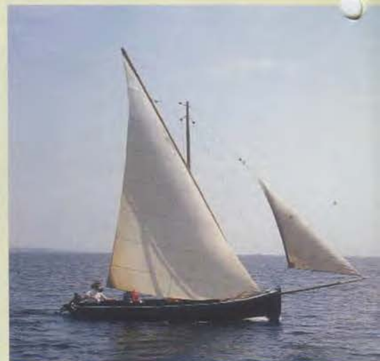
UN « PUCAN » DU CONNEMARA, POUR LA PÊCHE. INTERMÉDIAIRE ENTRE LE LÉGER CURRAGH DES ÎLES ET LE HOOKER, COTRE DE CABOTAGE.
