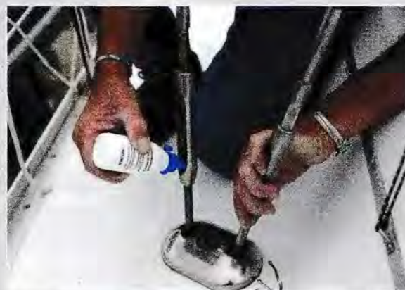
▲ Toujours mettre de l'huile sur les tiges filetées avant de régler.
