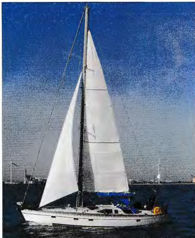
▲ Gréement continu en tête à deux étages de barres de flèche dans l'axe pour le Feeling 416. Pas de bas-étai mais une double paire de bas-haubans.
