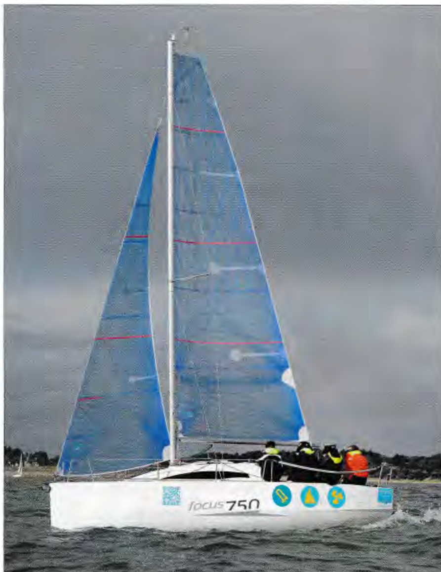
▲ Gréement fractionné en 7/8 à un seul étage de barres de flèche poussantes avec un mât posé sur le pont sur le Focus 750. Bas-hauban et galhauban se retrouvent sur la même cadène.
