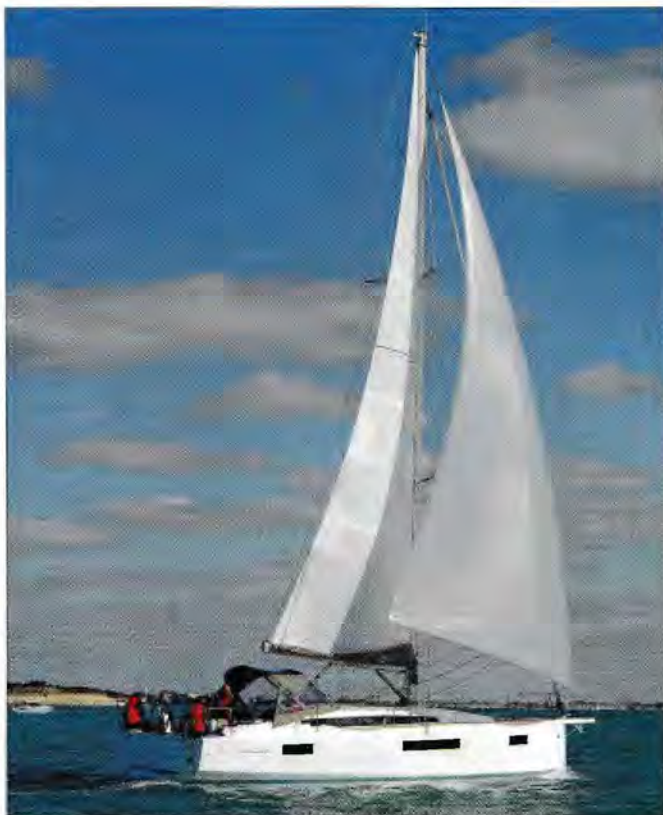
▲ Gréement discontinu fractionné en 9/10 à deux étages de barres de flèche poussantes pour le Sun Odyssey 411, élu Voilier de l'année 2018.
