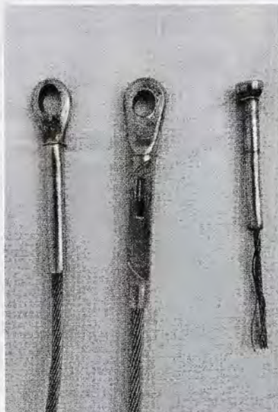
▲ Embout mal serti, détournage, fissure de l'œil nécessitent un changement immédiat.
