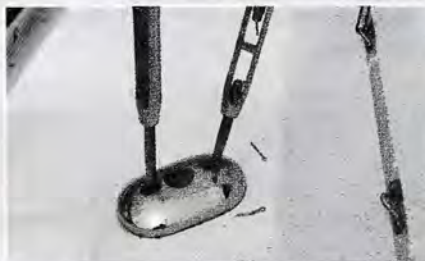
▲ Ridoirs et cadènes sont des pièces essentielles et faciles à contrôler avant et après navigations.
