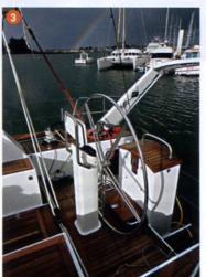
1 Les hiloires de cockpit protègent bien l'équipage et cachent des rangements pour le petit matériel. Q Génois et trinquette sont sur enrouleur pour faciliter les combinaisons de voilure. 🚯 Le barreur est très bien installé derrière sa grande barre à roue, laissant une circulation facile vers la jupe.
