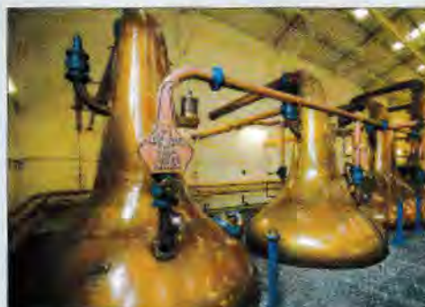
Les alambics utilisés pour la distillation des Single Malts sont de type pot still, comme ici à Talisker.
