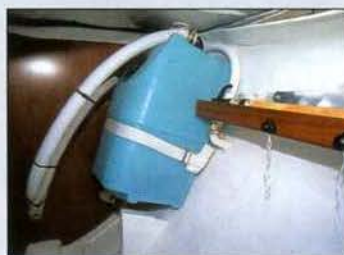
CUVE SUR LE SUN 2500, ELLE EST INSTALLÉE DANS LE COFFRE DU COCKPIT.
