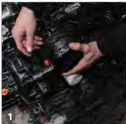
▲ Si votre moteur est équipé d'un filtre à air, déclipsez le porte-filtre.
