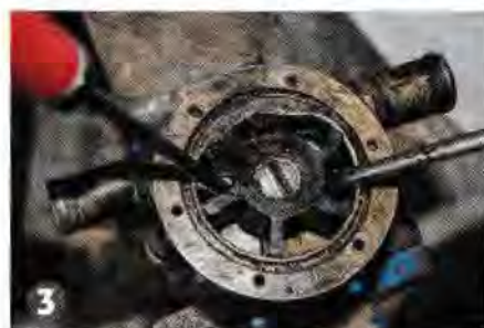
3 ▲ Sortez le rouet de pompe en le bloquant sur les côtés par deux tournevis.
