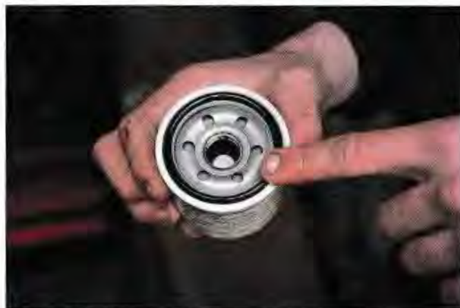
▲ Lubrifiez le joint du nouveau filtre avec de l'huile propre.
