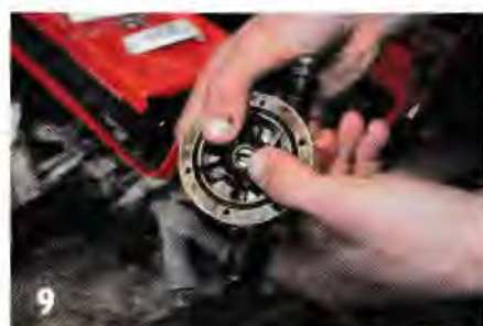
9 ▲ Insérez le rouet neuf en tournant dans le sens de rotation de la pompe.
