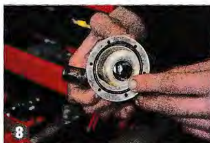
8 ▲ Changez le joint de la pompe et lubrifiez-le (idem s'il y a un joint papier).
