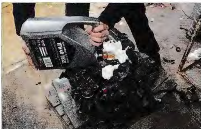
▲ Refaites le plein avec l'huile indiquée par le constructeur.
