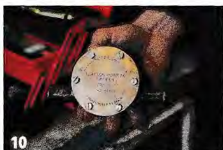
10 ▲ Revissez la plaque sans trop forcer sur les vis qui sont assez fragiles (parfois des neuves sont comprises dans le kit).
