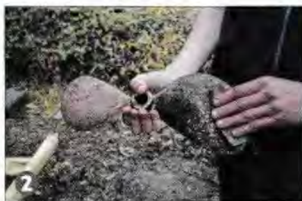
2 ▲ Vérifiez l'état de l'hélice (chocs, microfêlures) et poncez-la au grain 120.
