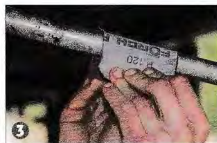
3 ▲ Retirez les coquillages à la spatule et nettoyez l'arbre (toile émeri P120).
