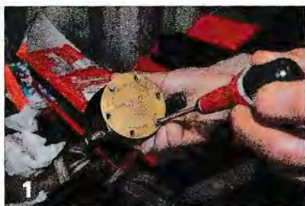
1 ▲ Démontez la plaque de la pompe à eau de mer avec un tournevis plat.
