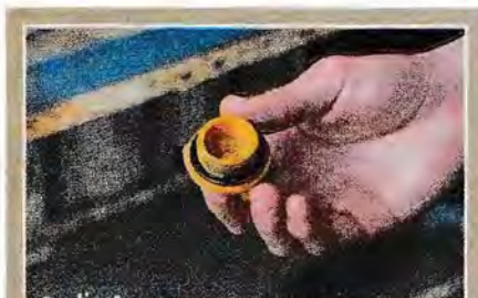
▲ Refaites le plein avec l'huile indiquée par le constructeur.
