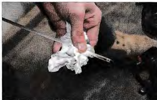
▲ Contrôlez le niveau. Faites un second contrôle bateau à plat et quand le moteur a tourné.
