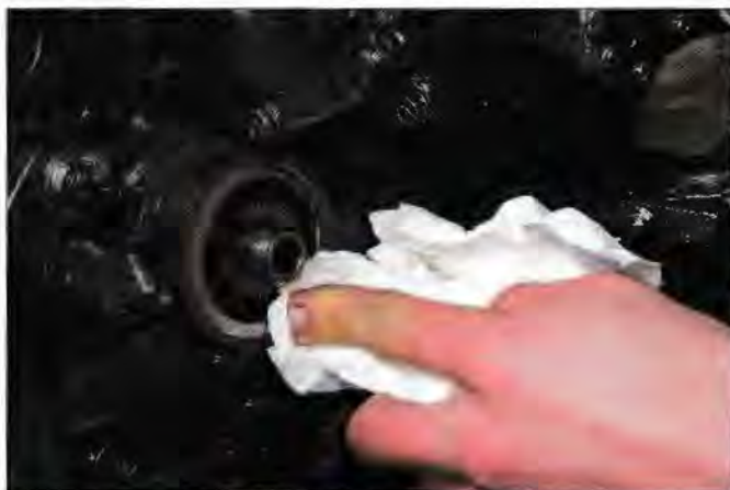
▲ Nettoyez la portée du filtre avec un chiffon propre.
