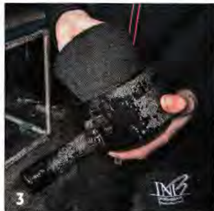
▲ Mettez le nouveau filtre en place puis remontez le porte-filtre.
