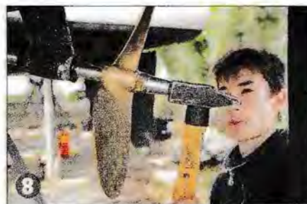
8 ▲ Ecrasez (modérément !) l'anode contre l'écrou avec un marteau.
