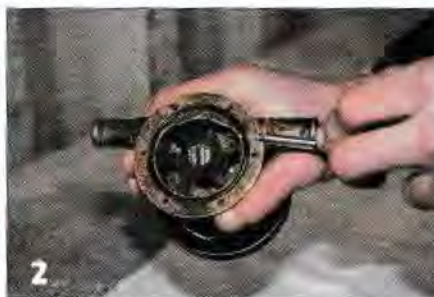
2 ▲ Retirez le joint de la gorge (ou le filtre papier, selon le modèle de pompe).
