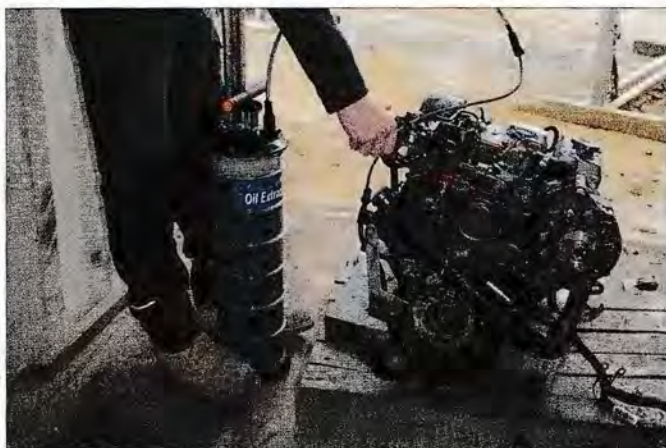
▲ Faites chauffer le moteur. Retirez la jauge et vidangez l'huile.
