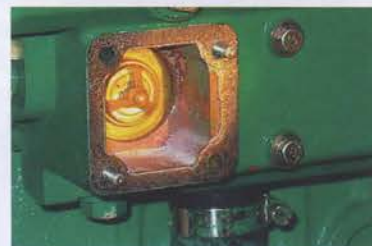
THERMOSTAT : LE MOTEUR FONCTIONNE À LA RIGUEUR AUSSI SANS LUI... MAIS MAL.
