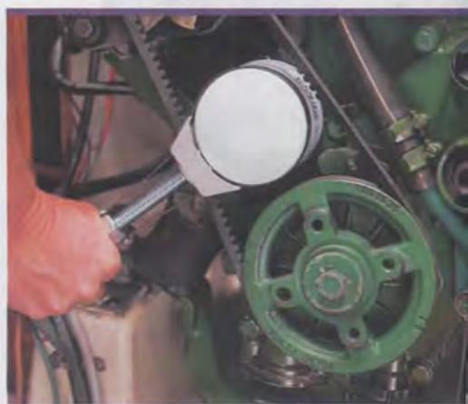
**5 La clé !** Une clé à filtre type auto, peu coûteuse, doit faire partie de la boîte à outils du bord. Métallique de préférence, à serrage par vissage, elle débloquera n'importe quel filtre sans problème.
