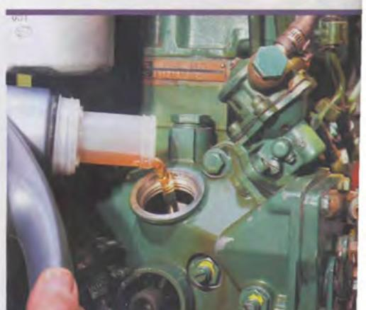
**9 Le plein.** Guère besoin d'entonnoir avec cette ouverture et ce tube verseur de bidon pour faire ce plein d'huile. Respecter la quantité préconisée par le constructeur. Vérifier le niveau après quelques minutes et, surtout, après redémarrage.
