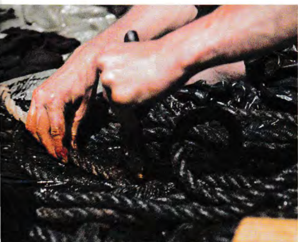
Entretien constant. Rien ne vaut le coaltar – aussi appelé goudron de houille – pour protéger et étanchéifier les manœuvres dormantes et courantes.
