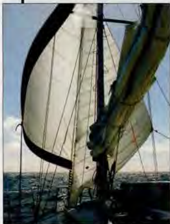
▲ Trinquette d'un bord et génois de l'autre : une image classique de grande traversée.
