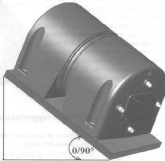
En maintenant la partie arrière du chauffe-eau (top) en hauteur il est possible d'effectuer l'installation sur un plan qui peut partir de 0° (montage horizontal au planché) jusqu'à arriver à n'importe quelle position intermédiaires à 90° (montage vertical)
