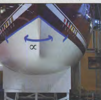
Sur ce Feeling, on a pincé les lignes d'eau pour fermer la carène assez volumineuse.
