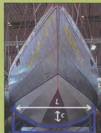
... et celle toute ronde (bouchains mis à part) d'un Ovni.
