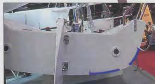
La forme en «U» caractéristique du J 80. On est en présence d'un bouchain, même s'il n'est pas vif.
