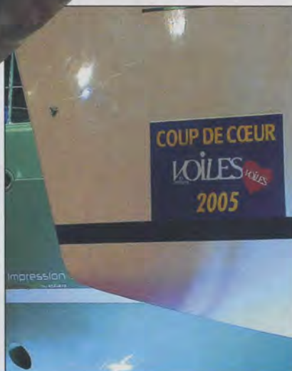
Les étraves modernes, peu pentues, permettent de maximiser les longueurs de flottaison.
