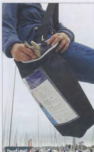
▲ Un mousqueton que l'on fixe sur la manille du bloqueur permet de rapprocher la chaise de la tête de mât.
