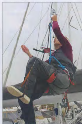
▲ Dès que L'Olivette est sous tension, elle se bloque sur la drisse en forçant celle-ci à former un S.
