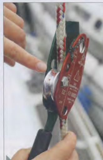
Le frottement des coins peut user la gaine de la drisse.
