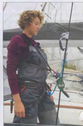
▲ Une courroie passée autour du cou et reliée à L'Olivette améliore l'efficacité à la montée.
