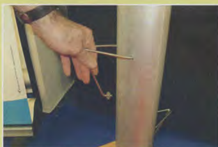
▲ Pas bêtes, ces marches de mât que l'on peut fixer puis ôter au fur et à mesure de l'ascension. Elles sont proposées par Cap Horn, au Canada.
