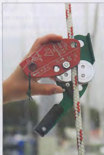
▲ Pour permettre à L'Olivette de coulisser à l'ascension, les coins sont dans le même axe que la drisse.
