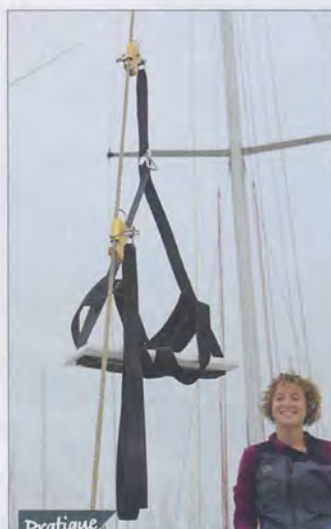
▲ Un mousqueton que l'on fixe sur la manille du bloqueur permet de rapprocher la chaise de la tête de mât.
