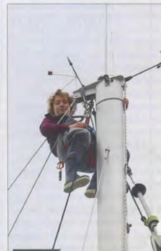
Une sangle fixée au harnais permet d'arriver en butée.
