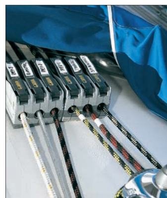
Choquer la drisse de grand-voile jusqu'à la marque du point de prise de ris.
