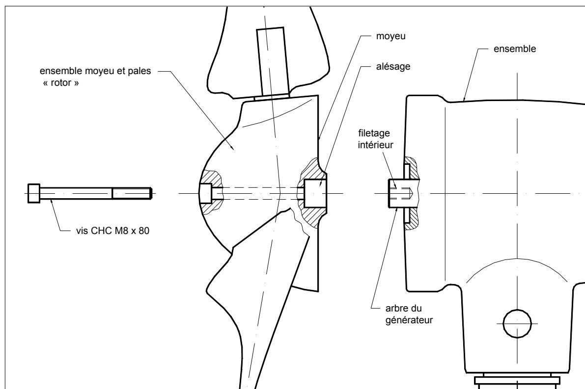
**REMARQUE:** Pour éviter d'endommager l'intérieur du générateur ne pas pousser l'arbre du générateur dans le logement du générateur (perte de la garantie !).
