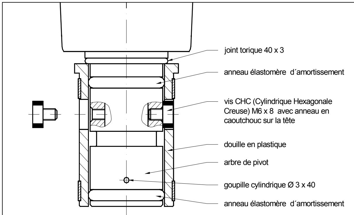
Pour le montage sur des mâts tubulaires de diamètre intérieur 55,0 mm les deux bagues d'ajustage doivent être retirées de la douille en plastique avant d'effectuer la prochaine étape d'assemblage.
