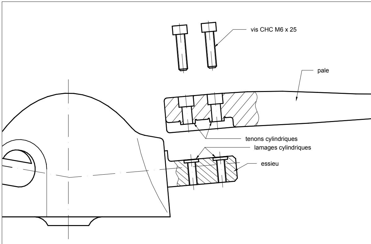
Les pales sont fixées sur les essieux par deux vis CHC M6 x 25. Ils sont enduis d'un frein filet TUFLOK pour éviter leur desserrage. De ce fait, ils peuvent être un peu durs à visser.
