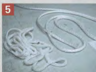
5 Remonter la gaine intermédiaire jusqu'à la marque (1,76 m) et la couper.
