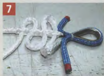
7 Mettre la cosse en place. La bloquer avec une surliure. Passer ensuite le cordage toutes les deux mailles sur une longueur de 80 cm et le ressortir.
