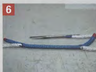
6 Prendre le morceau de la gaine extérieure (bleue) correspondant au périmètre de la cosse et y insérer le cordage.
