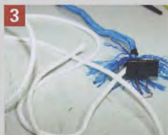
3 Remonter la gaine extérieure (bleue) jusqu'au nœud.
