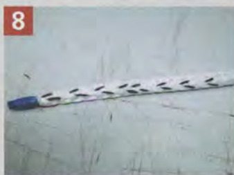
8 Tracer une queue-de-rat (marques noires) et couper au niveau des marques pour réduire le diamètre et faire une épissure dégradée.
