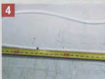
4 Prendre une longueur de 1,76 m correspondant à 80 cm + 16 cm (longueur de la cosse) + 80 cm. Marquer le cordage à cet endroit.
