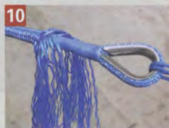
10 Remonter la gaine extérieure (bleue) et couper le surplus de gaine. Terminer par une surliure.
